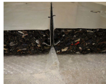
Bild 2: Blechwanne mit Dämmplatte
